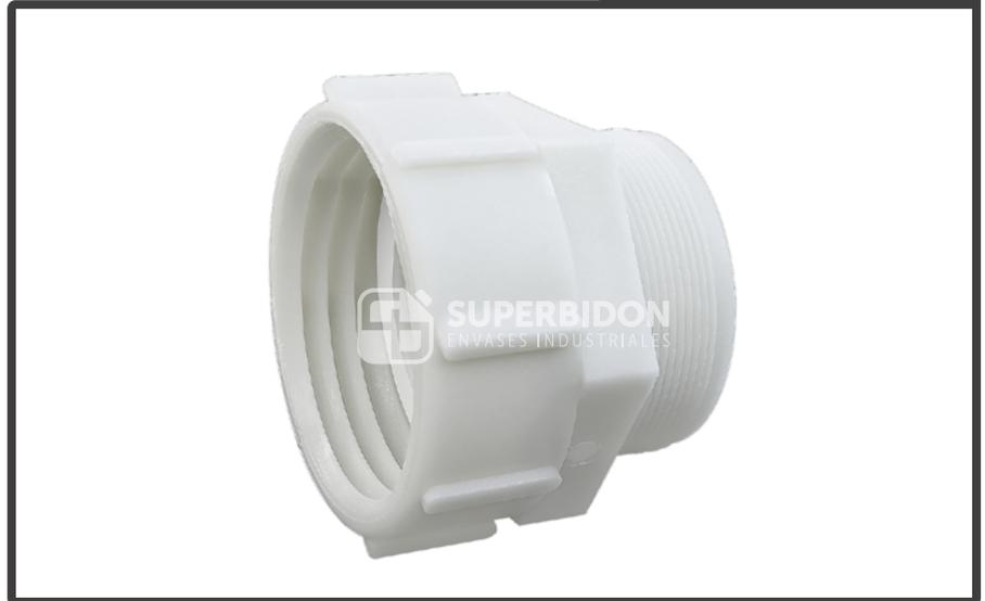
Este adaptador está diseñado para conectar válvulas de estanques IBC con rosca gruesa de 3 pulgadas a hilos finos de 3 pulgadas, proporcionando una solución confiable y segura. Facilita la conexión y desconexión de manera eficiente, asegurando un trasvase fluido de líquidos sin complicaciones.
